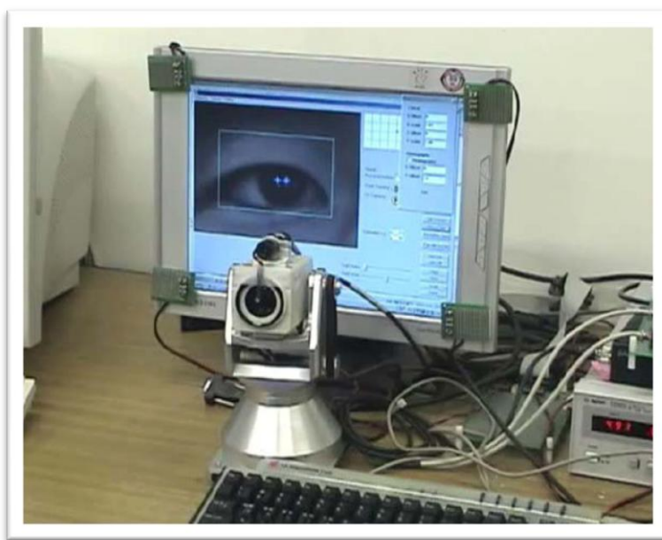
System zbudowany z 5 LED IR oraz 2 kamer [111]
