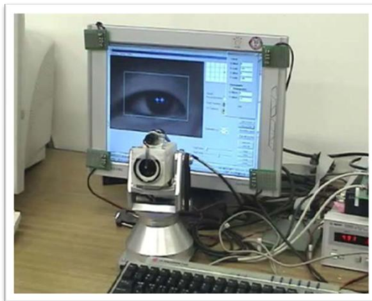
Rys. 3.4. System zbudowany z 5 LED IR oraz 2 kamer [3]
